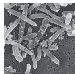
Vista microscopica delle alghe presenti nel carburante
